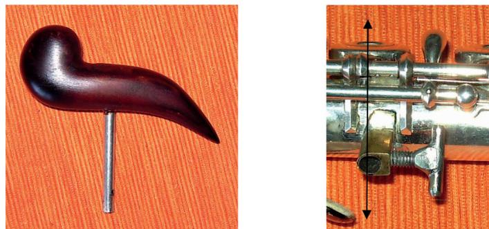
Para sujetar el soporte a la flauta le he soldado justo detrás de la llave de Mi, una base con un tornillo para fijar la varilla en la posición idónea. La base está en línea longitudinalmente con el centro de las llaves de trino, la del Sol Sostenido y la del Si natural, y transversalmente con el centro de la llave de Mi natural
