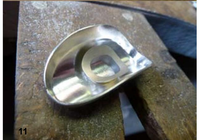
5 perfilando las llaves. 6 llaves listas para doblar. 7 costillas. 8 aspecto de los agujeros soldados. 9 conexiones traseras. 10 ensamblando el mecanismo. 11 chimenea soldada a la placa de la embocadura
