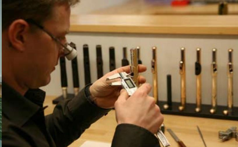
Arriba a la izquierda sala de máquinas. Debajo sala de trabajo. Sobre estas líneas el propio Mancke comprobando el calibre de una embocadura.
