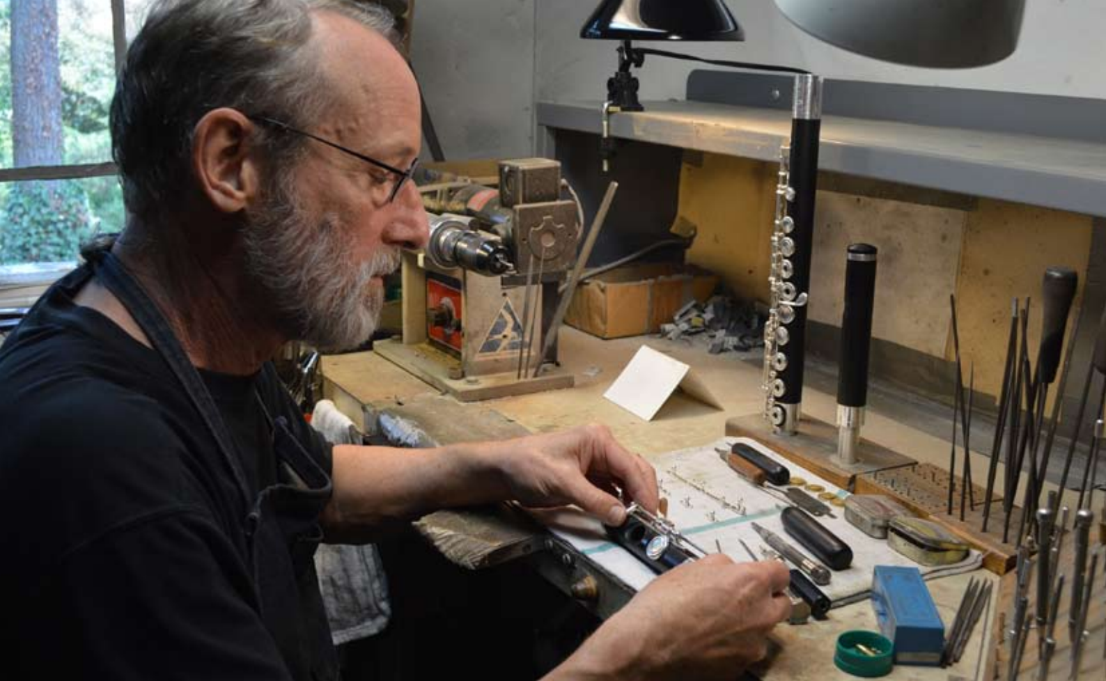
Chris Abell en su taller. Derecha perfilado manual del agujero de la embocadura.
