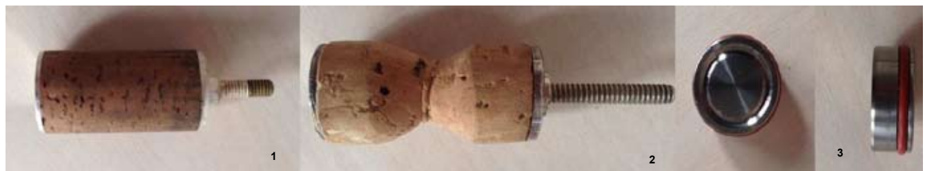
Figura 2. Tapón de corcho 1, habitual para flauta travesera, 2, diseño particular realizado por D. R. Pérez Hernández y 3 tapón donde se ha utilizado sólo el tope, sin corcho.
