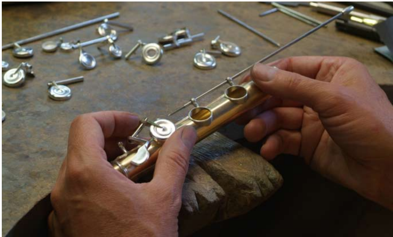
Proceso de montaje de la pata de Si
