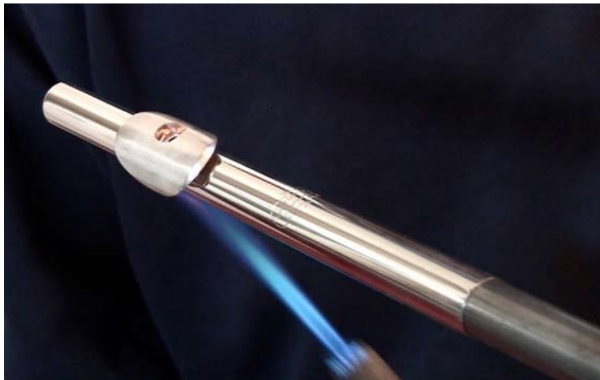
Arriba, soldado de la placa al tubo de la embocadura. Izquierda, detalle de una mariposa grabada en la placa de embocadura, por Ian Mclauchlan
