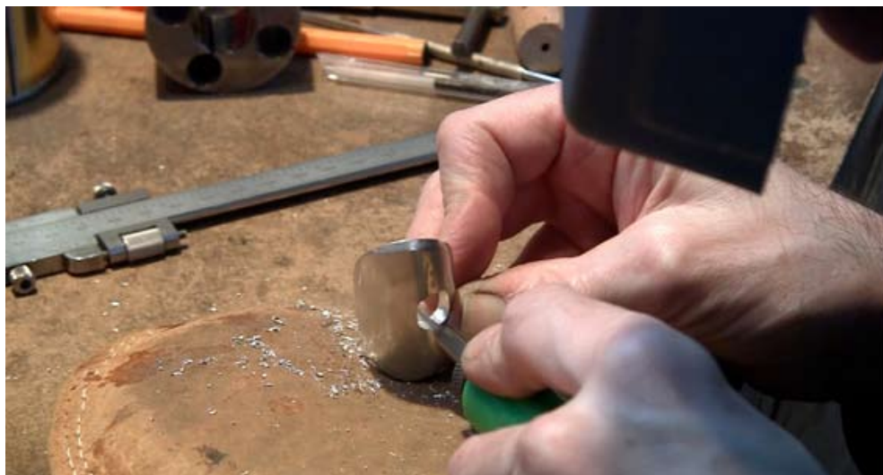
Proceso de corte manual del bisel de la embocadura.
